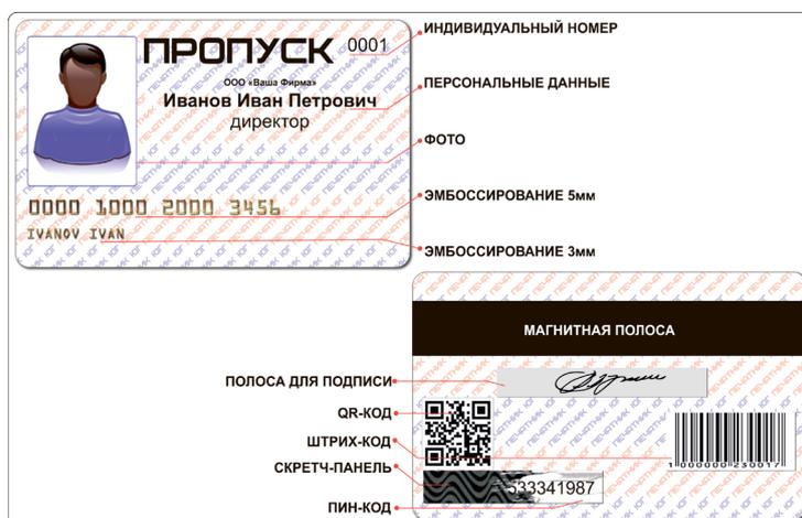
**Магнитная полоса** располагается на расстоянии 4,5 мм от края карты. Ширина полосы 12,7 мм. Отступ критичной информации от края магнитной полосы не менее 2,5 мм, желательно – 5 мм. На магнитную полосу можно записывать
